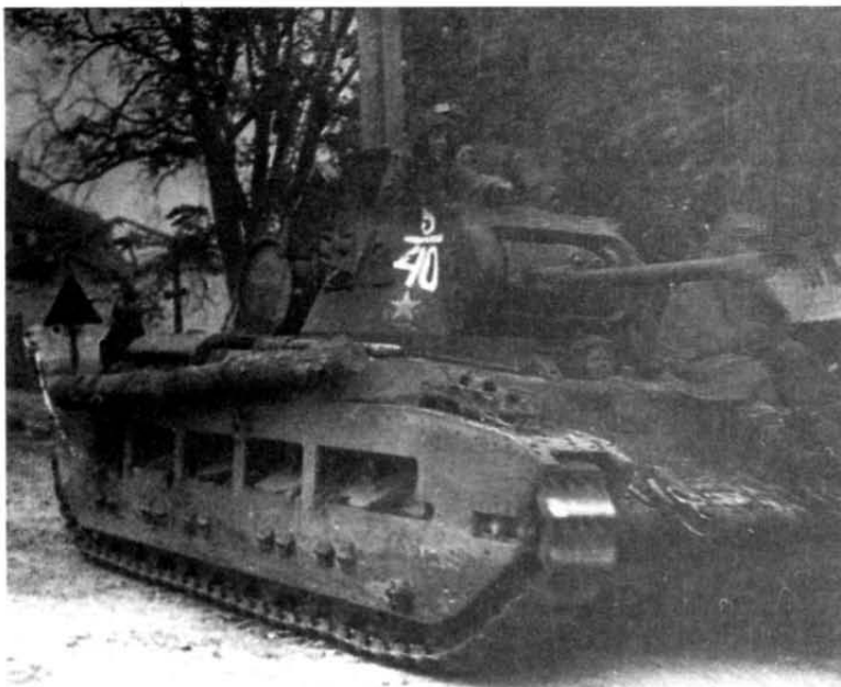
"Матильды" 5-го механизированного корпуса на марше. На переднем плане танк, вооруженный 76-мм гаубицей. Юго-Западный фронт, октябрь 1943 г.
