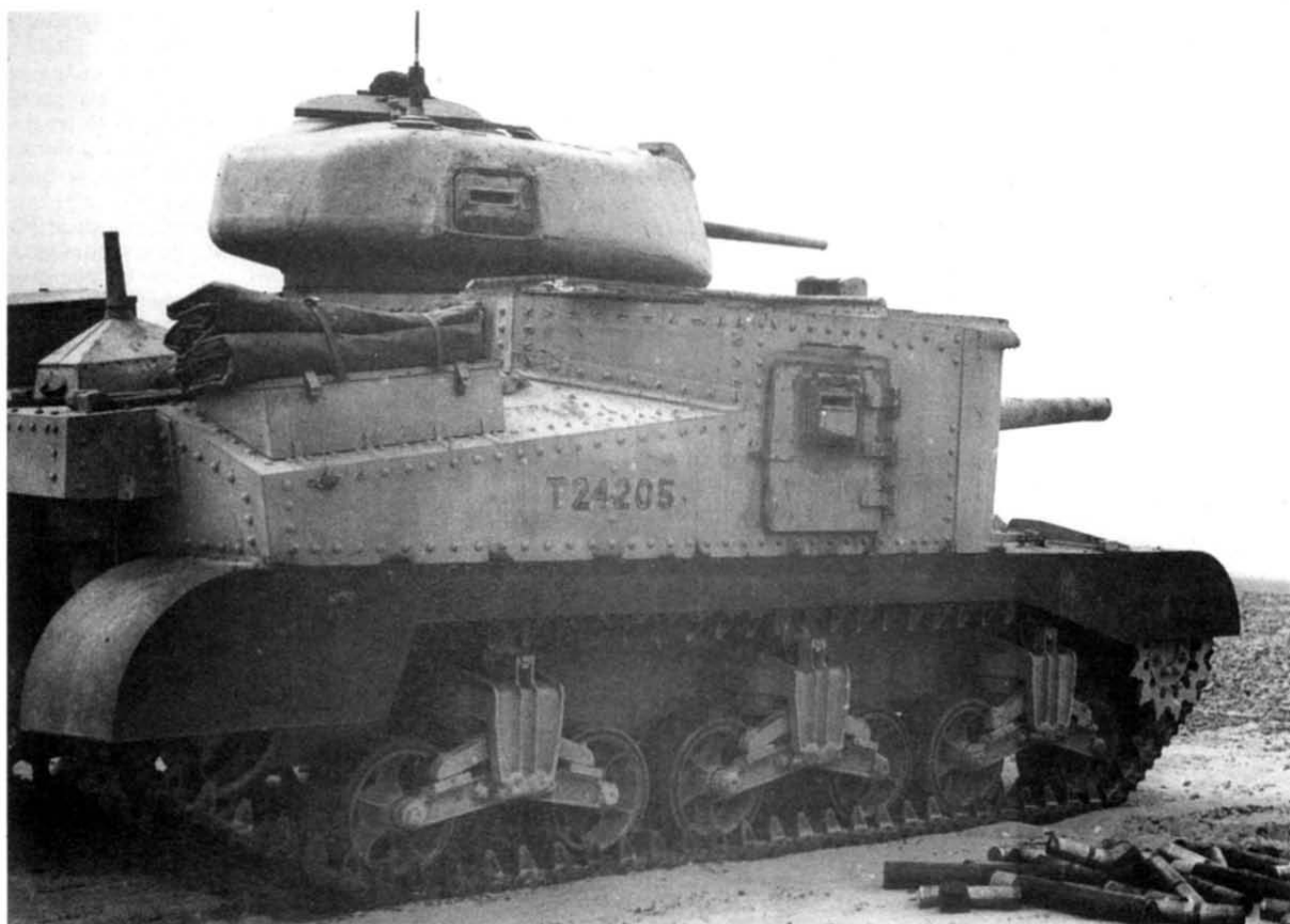
Танк "Генерал Грант" на боевой позиции в североафриканской пустыне. Стреляные 75-мм гильзы по- просту выбрасыва- лись через дверь в спонсоне
