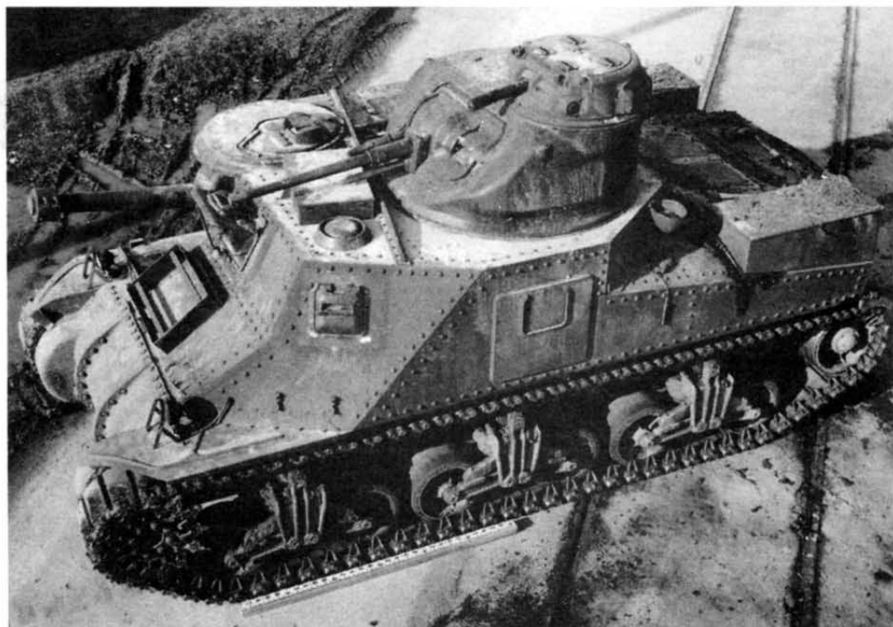
Средний танк М3А5 во время испытаний на Абердинском полигоне в декабре 1942 г. Машина поздних выпусков с вентилятором на крыше отделения управления, заваренной бортовой дверью и стабилизаторами пушек
