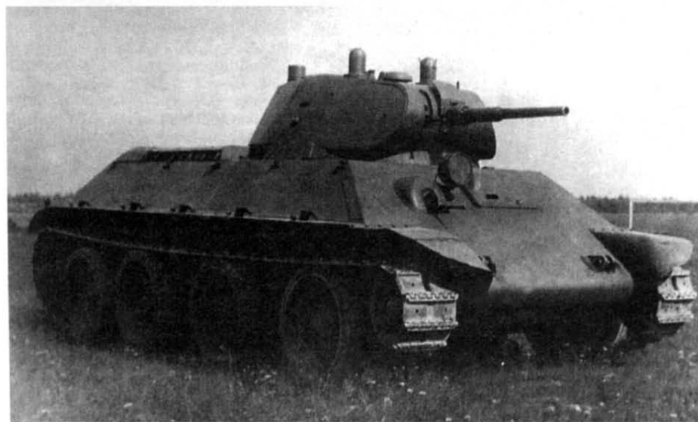
Опытный образец легкого колесно-гусеничного танка А-20. 1939 г.
