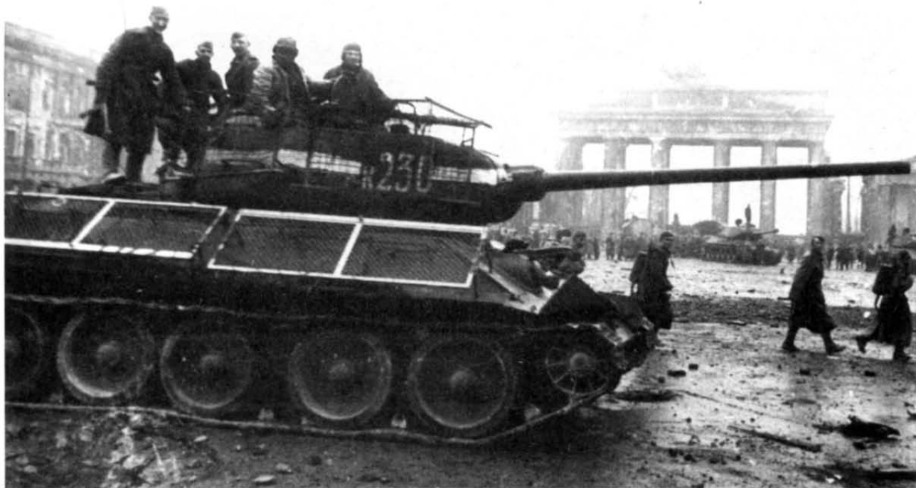
Т-34-85 у Бранденбургских ворот. Май 1945 г. Накануне штурма Берлина силами танкоремонтных мастерских было изготовлено большое количество противокумулятивных экранов разного типа
