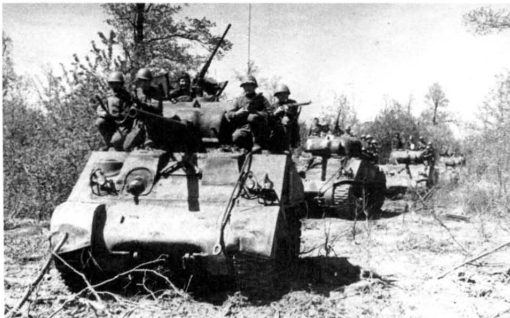
Колонна танков М4А2 Красной Армии с десантом на броне. 1943 год. Несмотря на плавный ход, удержаться на "Шермане" было делом трудным, поскольку на танке полностью отсутствовали какие-либо поручни или скобы. В американской армии мотопехоту перевозили на бронетранспортерах и автомобилях
