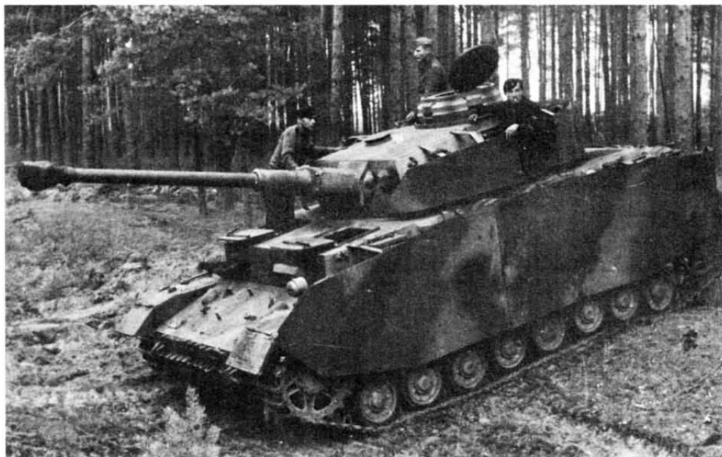
Pz.IV Ausf.J ранних выпусков. Почти полное внешнее соответствие модификации H (единственное отличие — отсутствие бортового прибора наблюдения механика-водителя), Восточный фронт, 1944 г.
