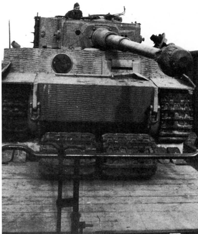
"Тигр" во время перевозки по железной дороге. Машина "обута" в транспортные гусеницы, боевые — уложены под танком
