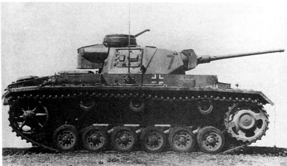
Средний танк Pz.III Ausf.L. На командирской башенке хорошо виден кронштейн для крепления зенитного пулемета
