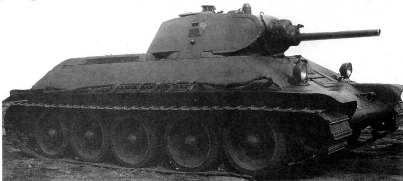
Серийный танк Т-34 выпуска 1940 г. с 76-мм пушкой Л-11 (вверху и внизу)
