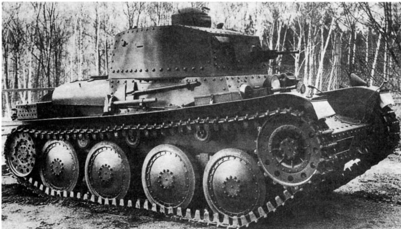
Легкий танк LT vz.40. с пулеметным вооружением
