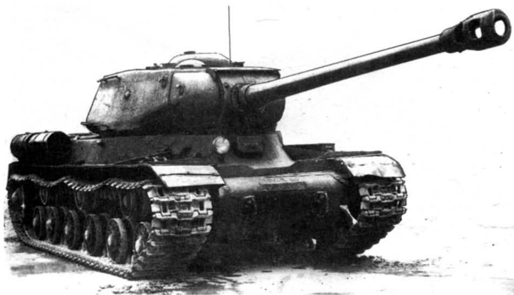
Тяжелый танк ИС-2 промежуточной модели, со старым корпусом с "ломаным носом" и новой башней
