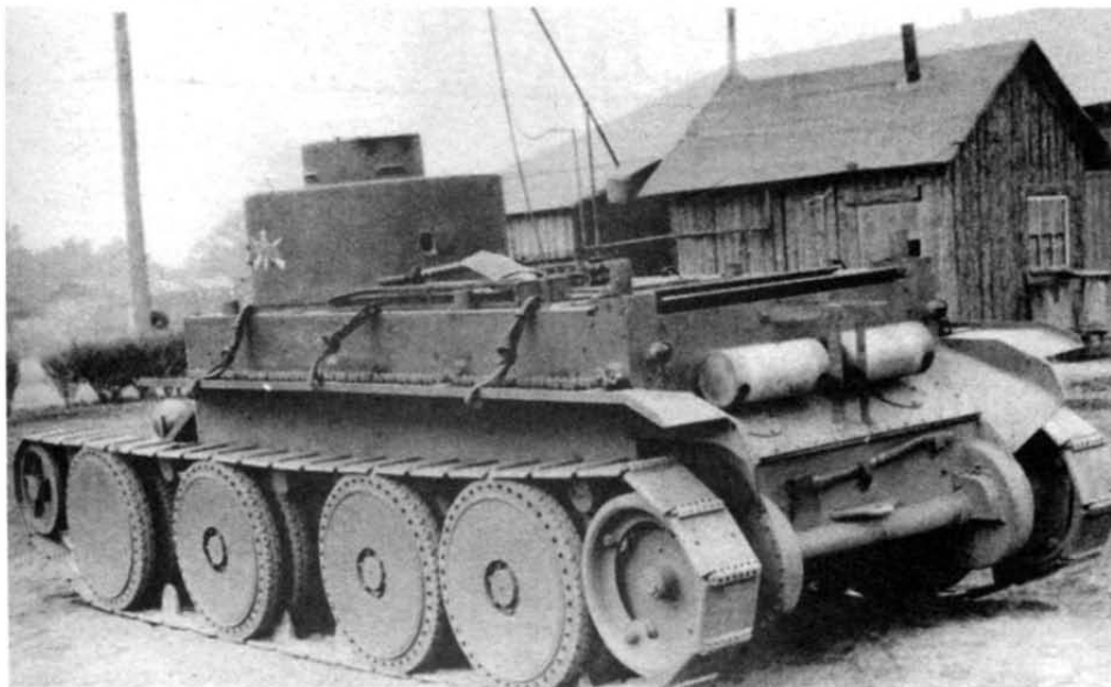
Средний танк Т3 конструкции У.Кристи во время опытной эксплуатации во 2-м (пехотном) полку средних танков. Форт Беннинг, 1932 г.
