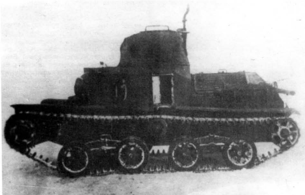
Трофейный легкий танк 2592 поздних выпусков с новой ходовой частью во время испытаний на НИБТПолигоне в Кубинке
