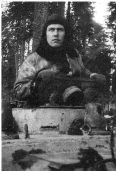
Старший лейтенант В.К.Прохоров следит за боем из своего танка. 1944 г. Хорошо видна командирская башенка танка Т-34 со смотровыми щелями. В передней створке крышки люка установлен прибор наблюдения МК-4, перед башенкой — перископический панорамный прицел ПТ-4-7
