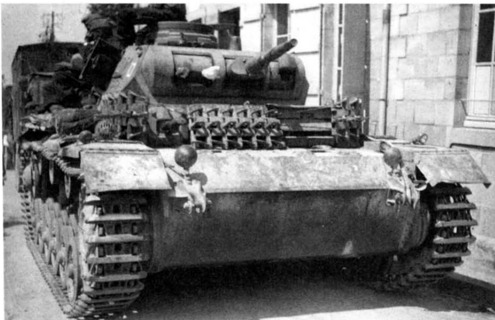
Средний танк Pz.III Ausf.E. Уже во время Французской кампании 1940 г. немцы начали использовать запасные гусеницы для усиления бронезащиты своих танков
