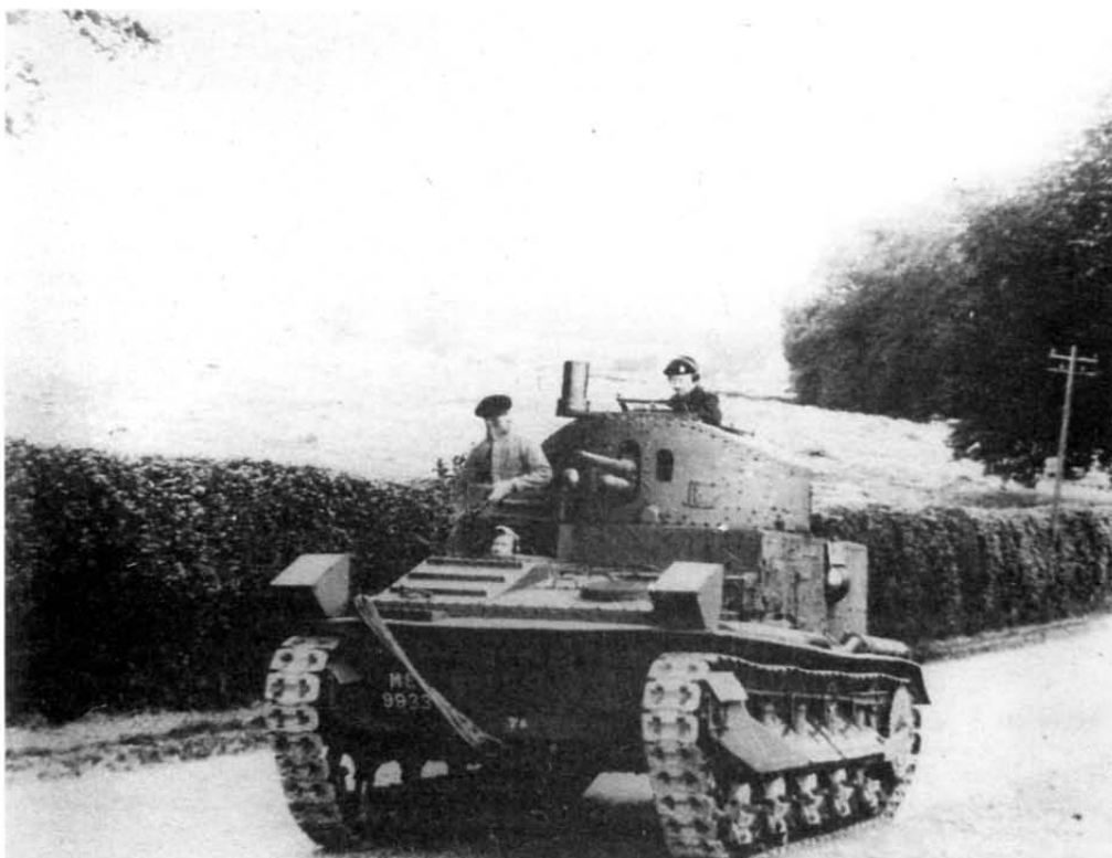
Средний танк Mk I. К началу Второй мировой войны таких машин практически не осталось. Цилиндр на башне танка — опора для установки штыревой радиоантенны
