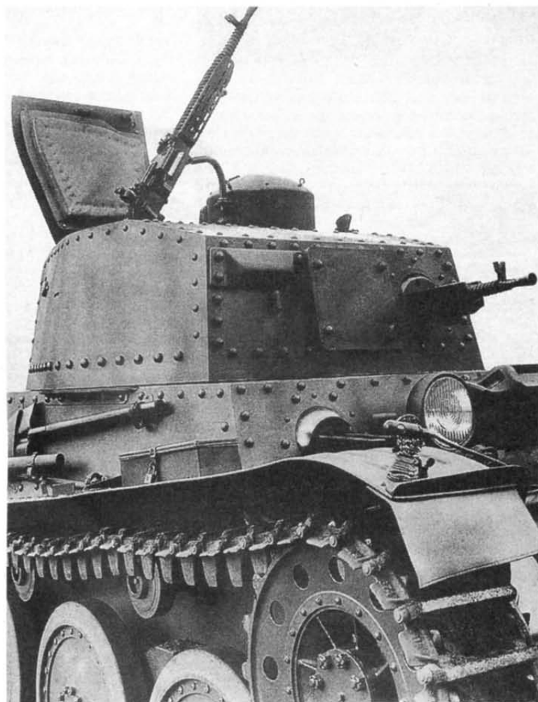
Легкий танк LT vz.40. с пулеметным вооружением. Амбразура пушки заглушена броневой заплаткой. У люка заряжающего установлен зенитный пулемет ZB vz.37
