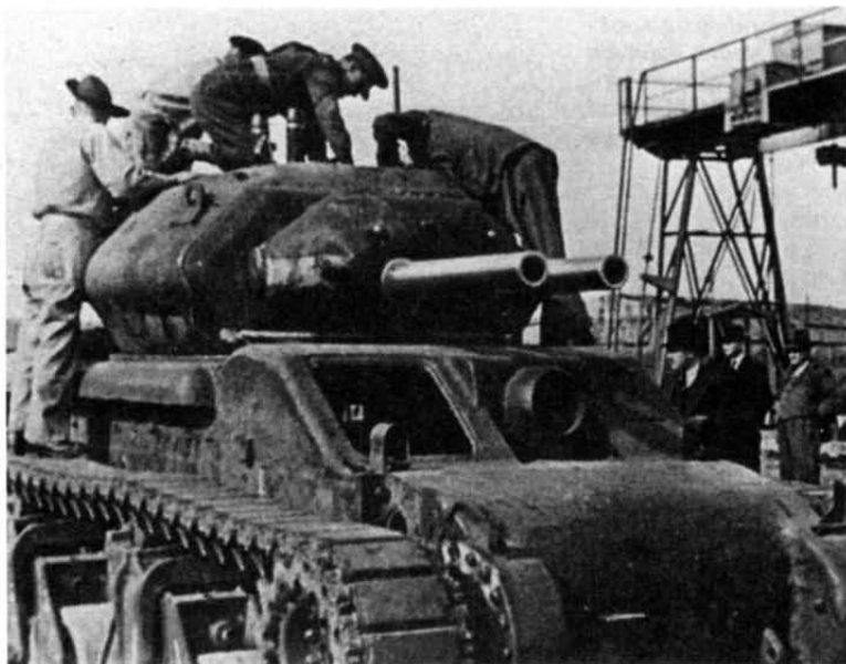
Сборка опытного образца танка Sentinel ACIII на заводе Chullora Tank Assembly Shops
