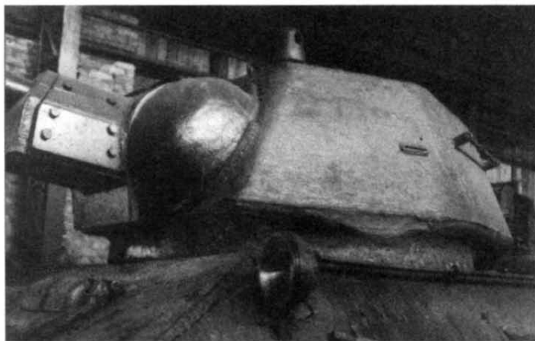
Литая "улучшенная" башня производства Уралмашзавода. 1942 г.
