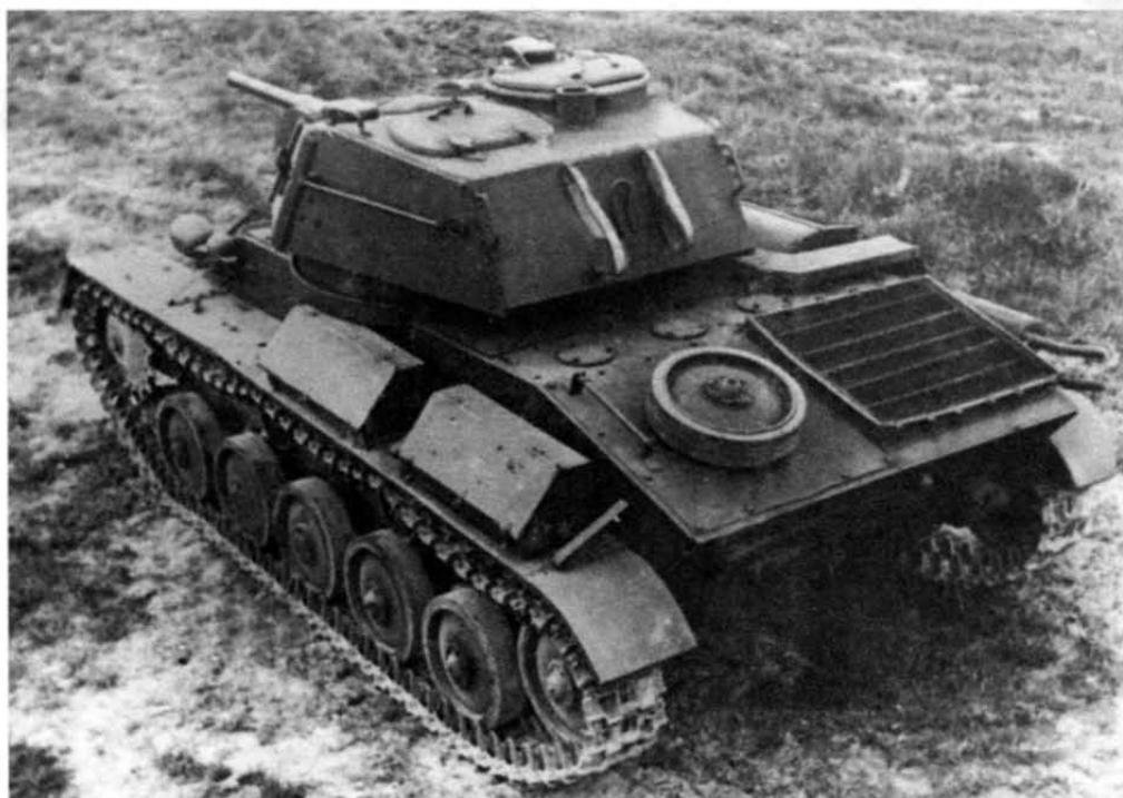
Легкий танк Т-80. Хорошо видно основное отличие от Т-70М — двухместная башня
