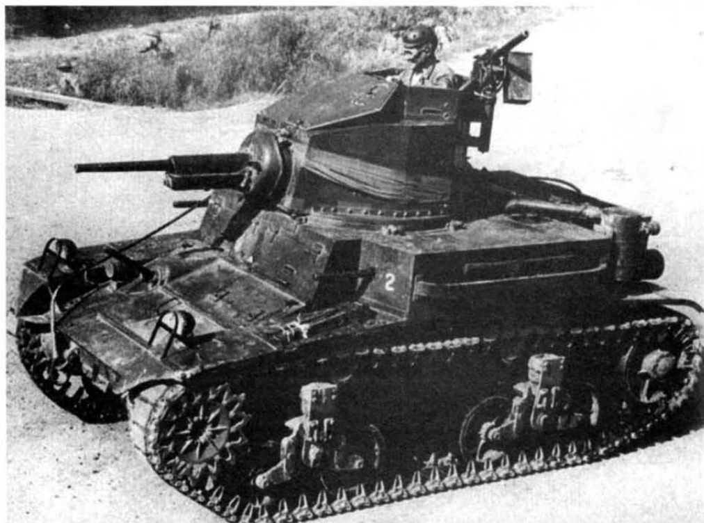
Легкий танк М2А4 из состава 2-й тан- ковой дивизии ар- мии США. 1941 г. Эта машина осна- щена дизельным двигателем Guiberson T-1020
