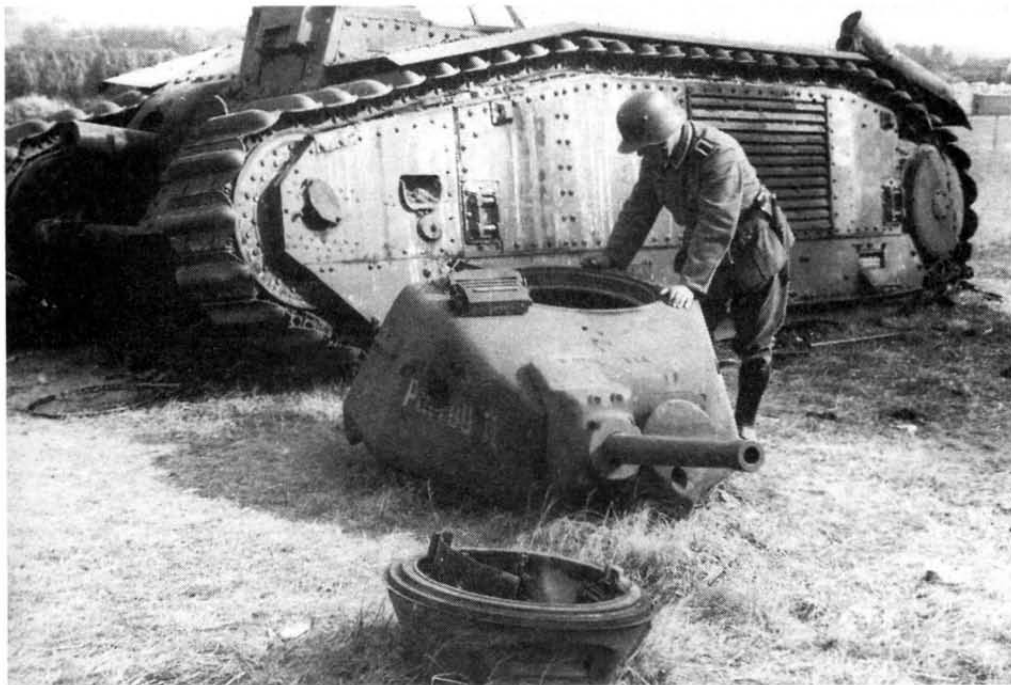
У этого B1bis взрывом боекомплекта сорвало и башню и командирскую башенку. Франция, май 1940 г.
