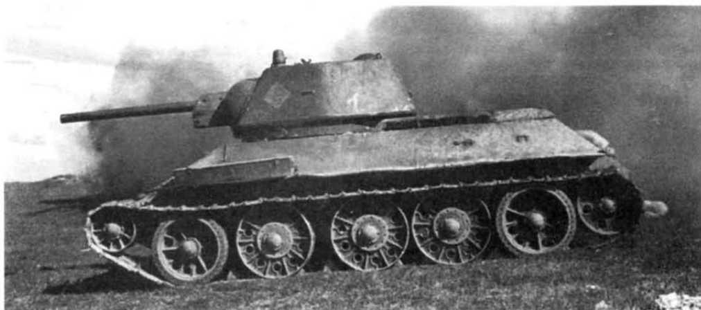
Т-34 выпуска 1942 г. с цельнолитым веду- щим колесом без роликов
