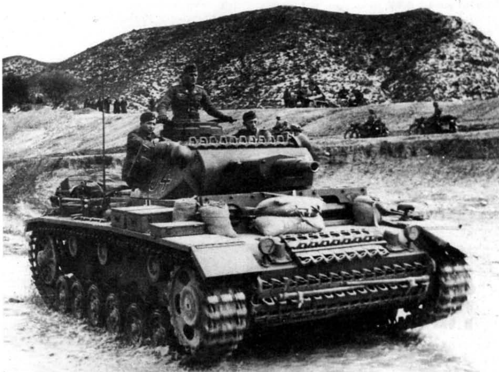
Танки сопровождения Pz.III Ausf.N из состава 501-го тяжелого танкового батальона. Тунис, конец 1942 г. Любыми средствами, включая мешки с песком, экипажи стремились повысить защищенность своих боевых машин
