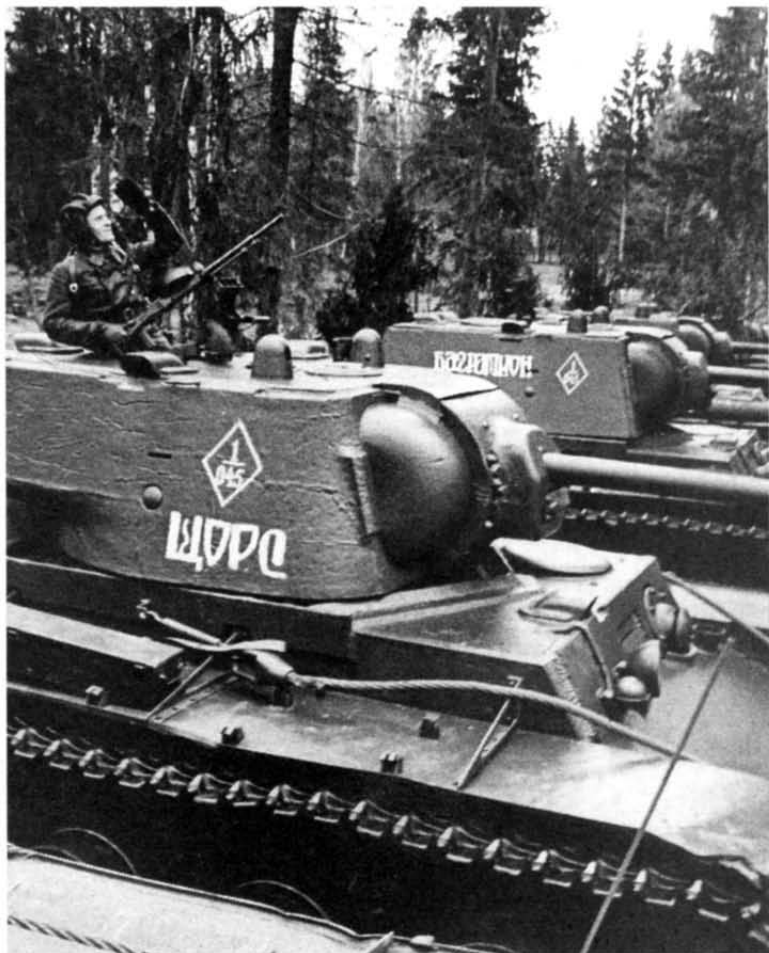
Танки KB-1 116-й танковой бригады. Западный фронт, апрель 1942 г. У танка "Щорс" башня литая, а у танка "Багратион" — сварная
