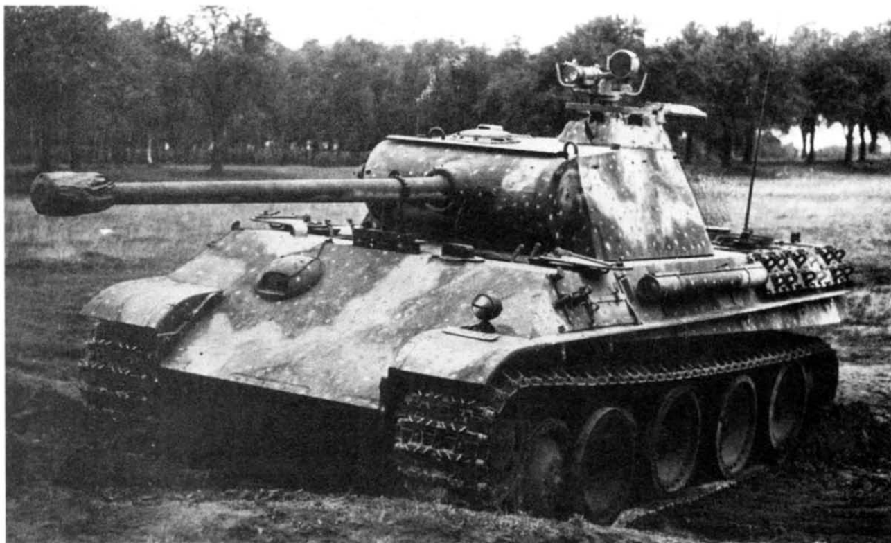
"Пантера" Ausf.G, с установленным на командирской башенке прибором ночного видения. На командирской башенке "Пантеры" смонтирован инфракрасный прожектор-осветитель мощностью 200 Вт и прибор, который позволял вести наблюдение за местностью на дистанции до 200 м
