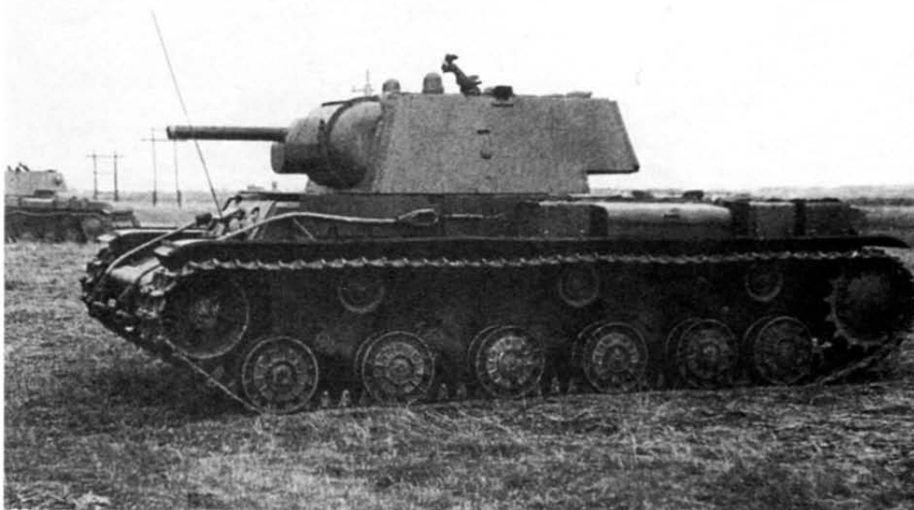
Танк КВ-1 с упрощенной башней, изготовленный на Кировском заводе в Ленинграде осенью 1941 г.
