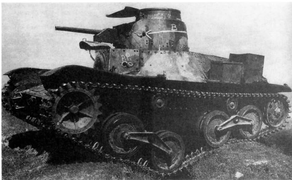
Трофейный танк "Ха-го" после испытаний обстрелом на Абердинском полигоне. 1945 г. На фото в центре хорошо видна характерная форма кормовой части башни
