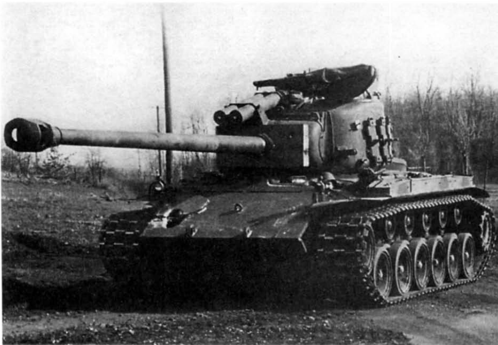
Тяжелый танк T26E1 с 90-мм пушкой T15E1. По прибытии на Европейский континент лобовая броня башни и корпуса этого танка была усилена бронелистами от танка "Пантера"
