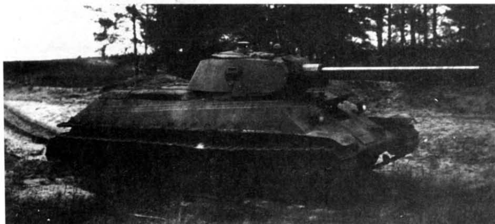
"Тридцатьчетверки", оборудованные дополнительной лобовой броней на СТЗ. Калининский фронт, 1942 г.
