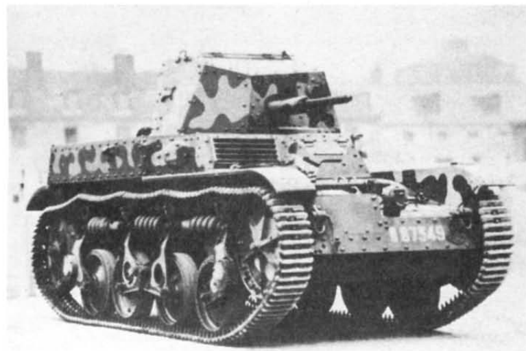
Легкий танк AMR 35ZT, вооруженный 13,2-мм пулеметом
