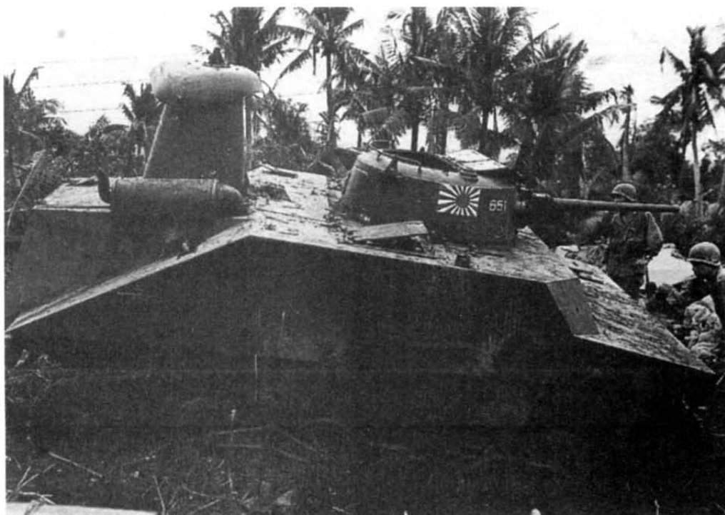
Американские солдаты осматривают подбитый танк "Ка-ми". Пирамидальный короб, установленный на крыше МТО предназначался для подачи воздуха к двигателю
