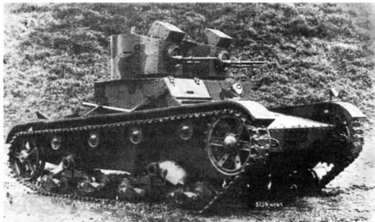
Легкий танк Vickers Mk.E mod.A изготовленный для Польши. 1932 г. Машина вооружена двумя пулеметами Hotchkiss
