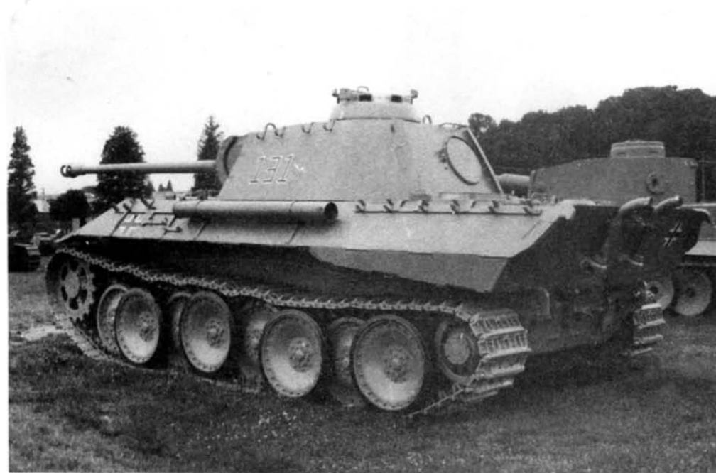
Трофейная "Пантера" модели A в экспозиции военного музея на территории Абердинского полигона, штат Мэриленд, США. Длинный цилиндр на борту танка- контейнер для хранения банника
