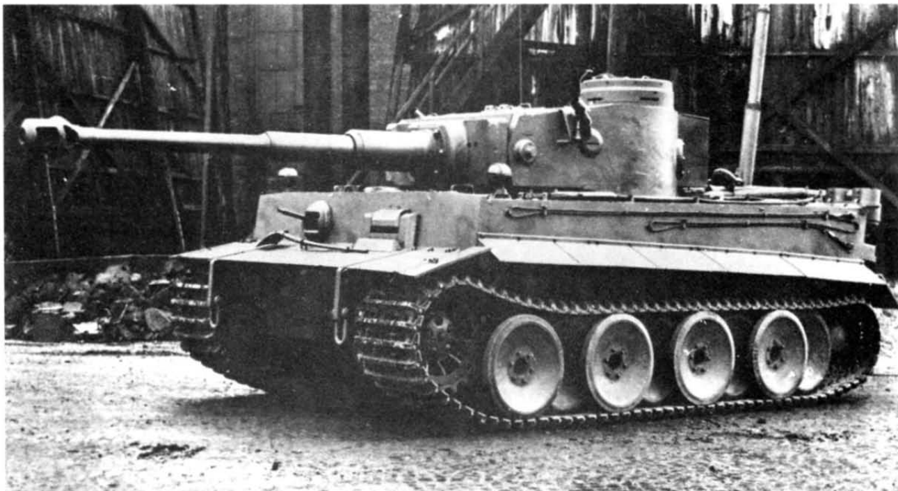
Первые 495 "тигров" оснащались оборудованием для подводного вождения, позволявшим преодолевать водные преграды глубиной до 4 м
