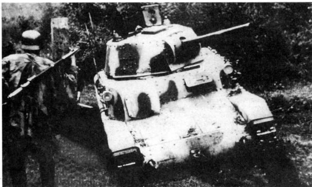
Танк Pz.Bef.Wg.M42(i) из состава 7-й добровольческой горнострелковой дивизии СС "Принц Евгений". Италия, 1944 г. Хорошо видны две антенны на корпусе машины и заглушенная амбразура спаренной установки 8-мм пулеметов Breda
