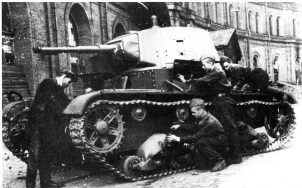
Ремонт танка Т-26 обр. 1938 г. Ленинг- рад, 1942 г.
