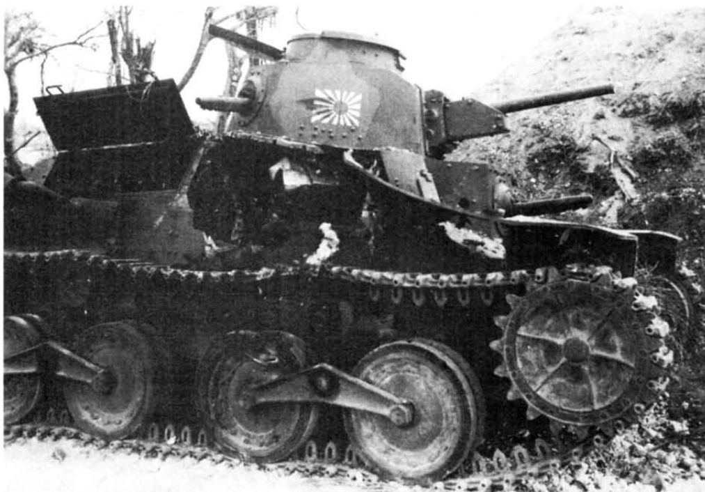
Танк "Ха-го" из состава 4-й роты 9-го японского танкового полка. Эта машина получила прямое попадание снаряда 75-мм американской танковой пушки. Сайпан, июнь 1944 г.
