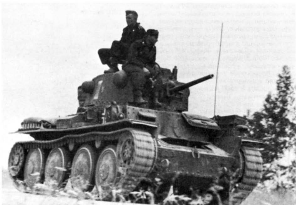
Pz.38(t) Ausf.B из состава 9-й танковой дивизии Вермахта. Восточный фронт, лето 1941 г. Судя по отсутствию курсового пулемета это командирская машина
