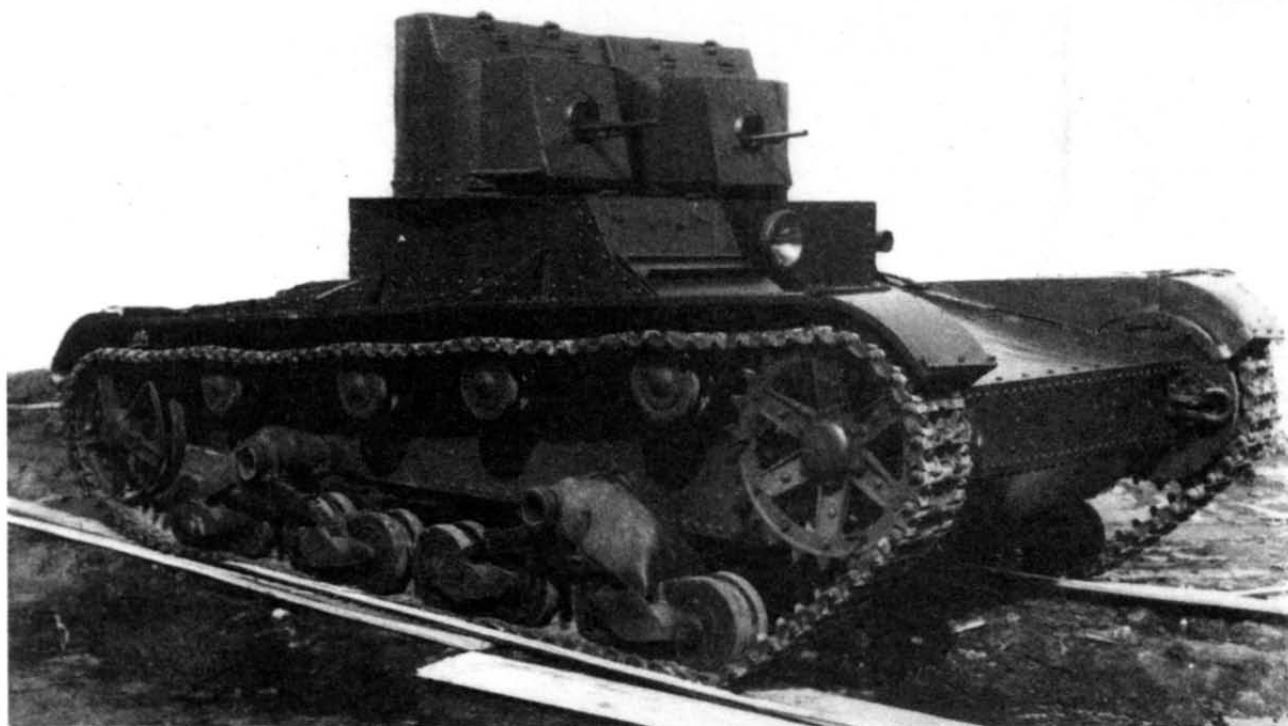
Легкий танк Т-26 обр. 1931 г. с пуле- метным вооружени- ем
