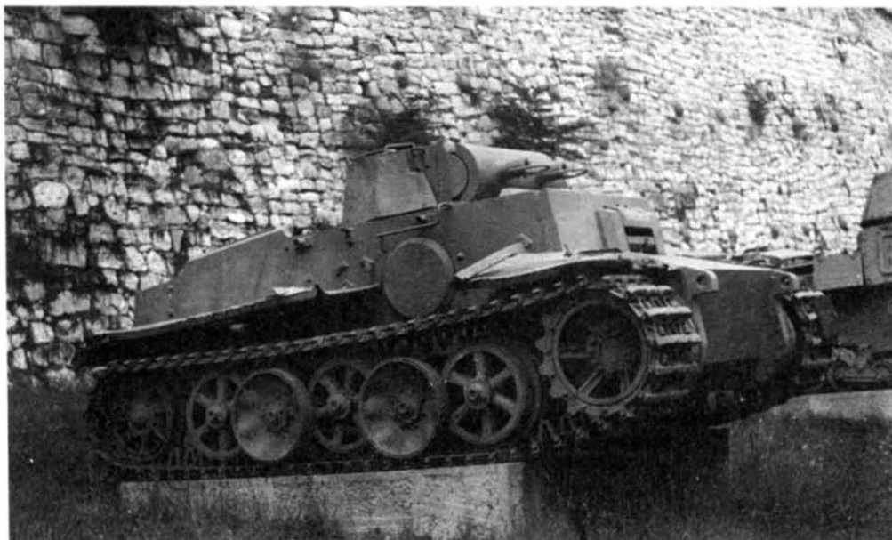
Pz.I Ausf.F в военном музее Белграда. У этой машины полностью отсутствуют резиновые бандажные опорные катки
