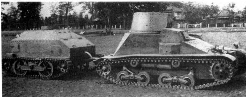
Малый танк 2592 с бронированным прицепом
