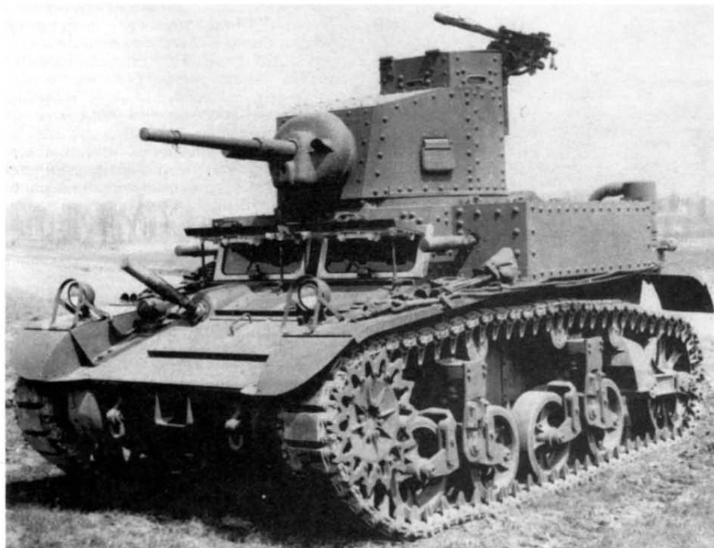
Один из первых серийных танков М3. 1941 г. У этой машины корпус и башня клепаные (слева). Танк М3 со сварной башней (внизу)
