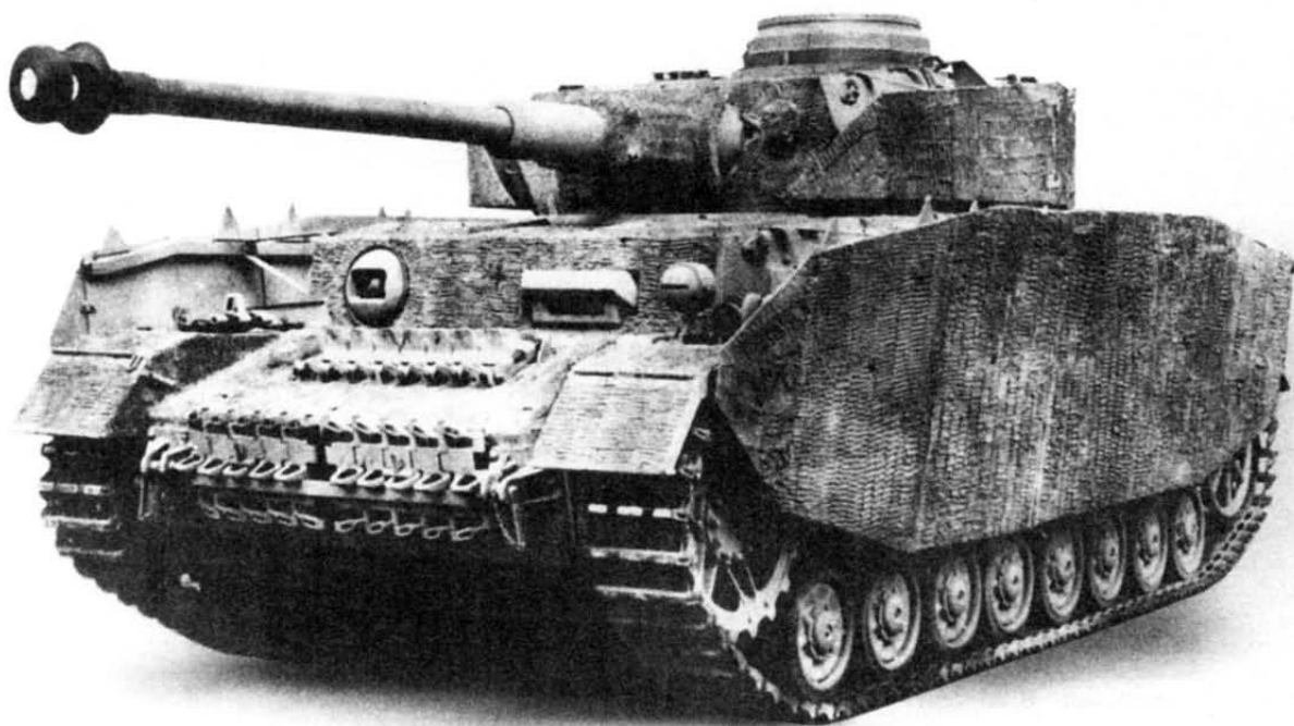
Pz.IV Ausf.H с полным комплектом бортовых экранов и нанесенным "циммеритным" покрытием
