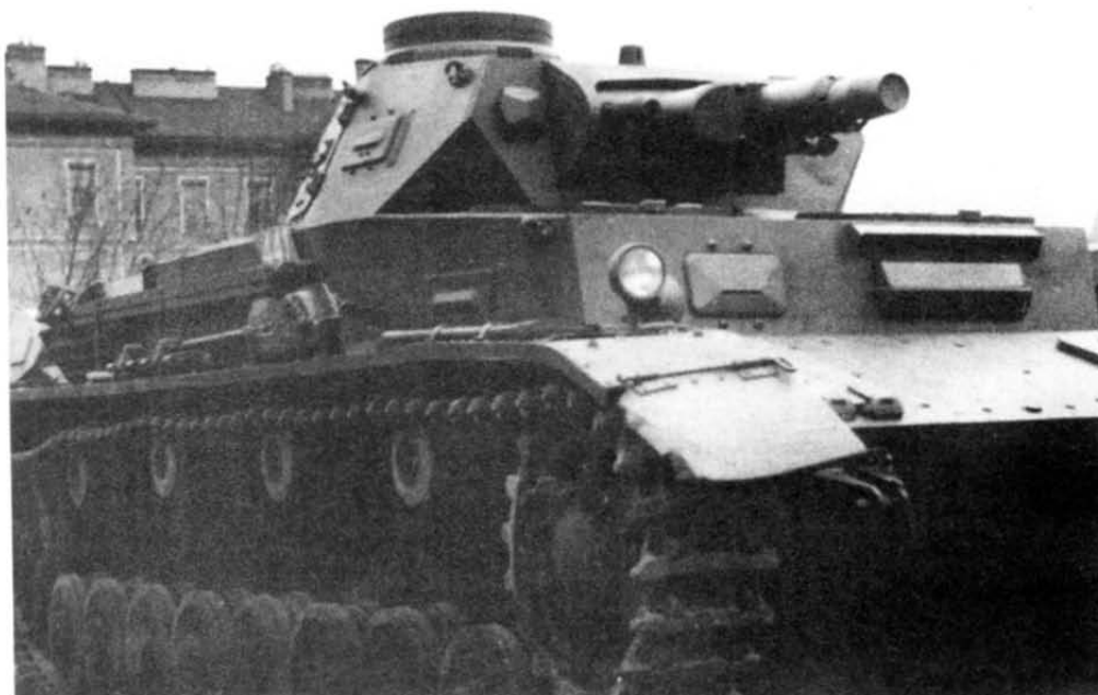
Pz.IV Ausf.C . Внешне эту машину можно было отличить от предыдущей модификации только по наличию броневых кожухов ствола спаренного пулемета
