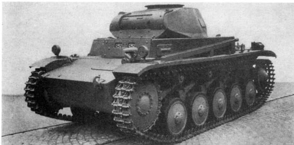
Легкий танк Pz.II Ausf.C на заводском дворе. Вооружение на танке не установлено
