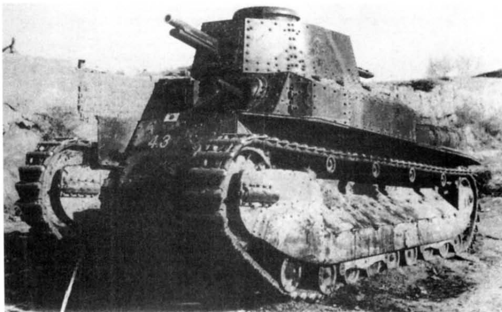
Средний танк 2594. Машины этой модификации легко опознать по измененному положению курсового пулемета
