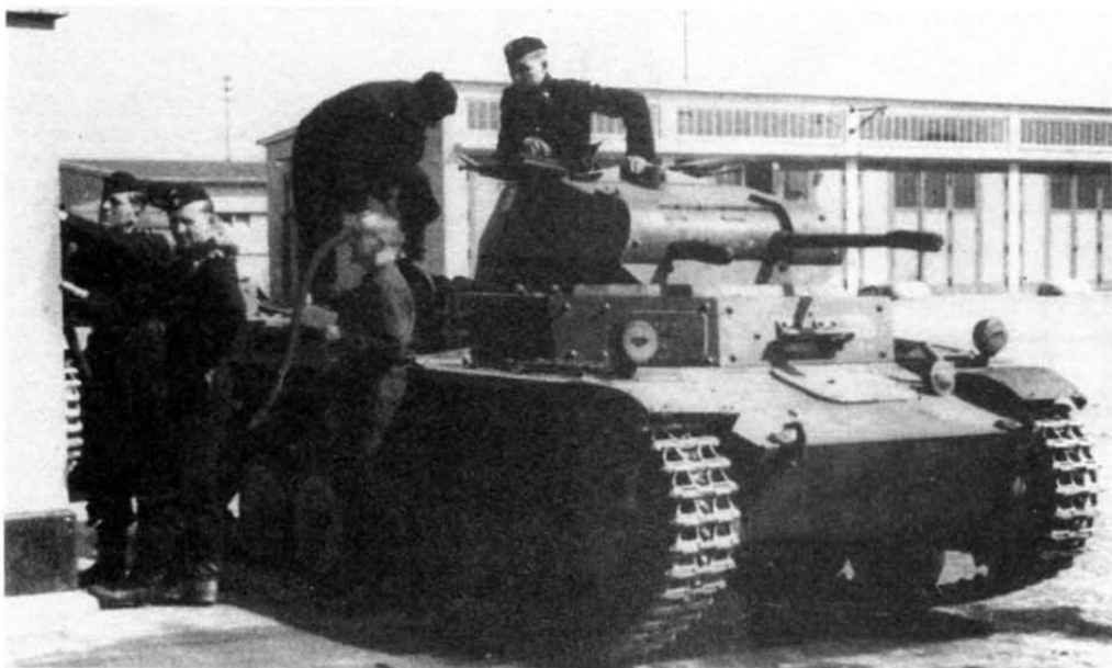
Заправка топливом танка Pz.II во 2-й танковой бригаде. После боев в Польше лобовая броня танков была усилена накладными листами. Оповестительный знак — черный крест в белой окантовке — был введен с 26 октября 1939 г.
