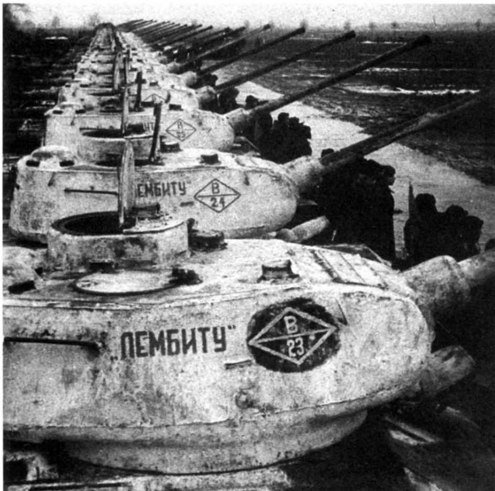
Передача Красной Армии колонны танков, построенных на средства трудящихся Эстонской ССР. 51-й танковый полк, зима 1945 г. Танки Т-34-85 выпуска 1945 г. легко отличить по одностворчатой крышке командирской башенки и приборам наблюдения МК-4 с крышечками
