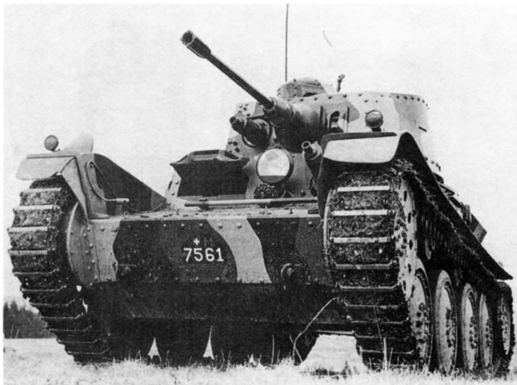
Легкий танк Pz.39 швейцарской армии (слева и внизу). Об- ращают на себя внимание характер- ные детали внешне- го облика боевой машины: маска гру- шевидной формы и дульный тормоз 24-мм пушки
