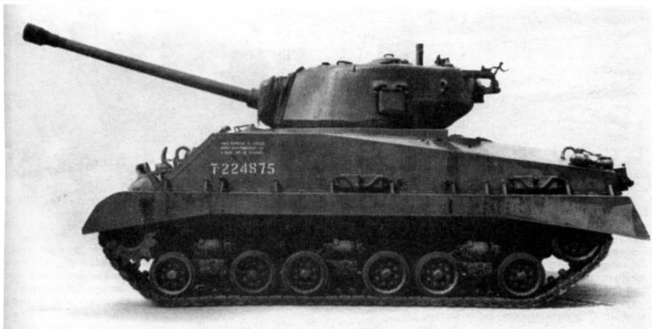
Средний танк М4А3(76)W HVSS. Машина оснащена горизонтальной подвеской и 76-мм пушкой М1А2 с дульным тормозом
