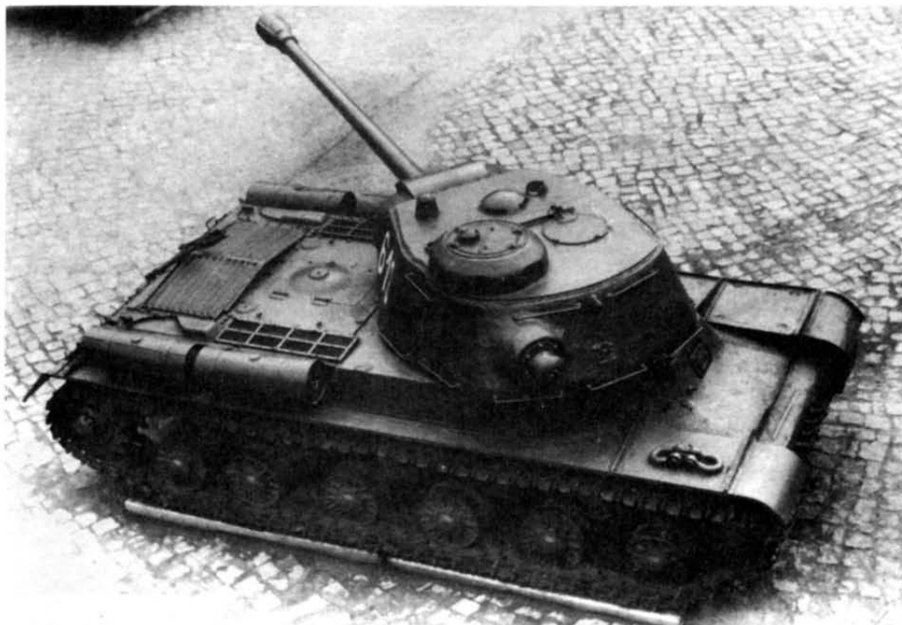
ИС-2 ранних выпусков 1944 года. Обращают на себя внимание характерные детали: литая лобовая часть с "ломаным" носом и люком-пробкой механика водителя; узкая амбразура пушки и броневой колпак перископического прицела ПТ4-17 перед командирской башенкой
