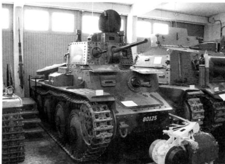
Легкий танк m/41 SII (в центре). Хорошо видны блоки дымовых гранатометов, установленные по бортам башни. Танк m/41 SI в шведском танковом музее (нижний снимок)
