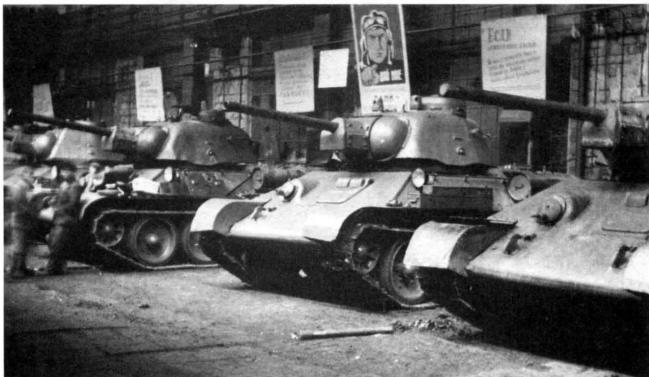
Танки Т-34 обр.1942 г. со штампованными башнями и командирскими башенками в цеху Челябинского Кировского завода. Октябрь, 1943 г.
