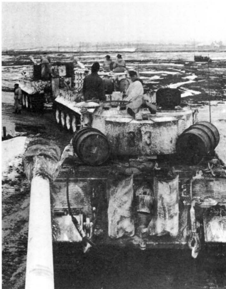
Колонна "тигров" 505-го тяжелого танкового батальона. Восточный фронт, весна 1944 г. Налицо стремление экипажей увеличить возимый запас топлива, хотя бы и за счет размещения на крыше МТО бочек с бензином
