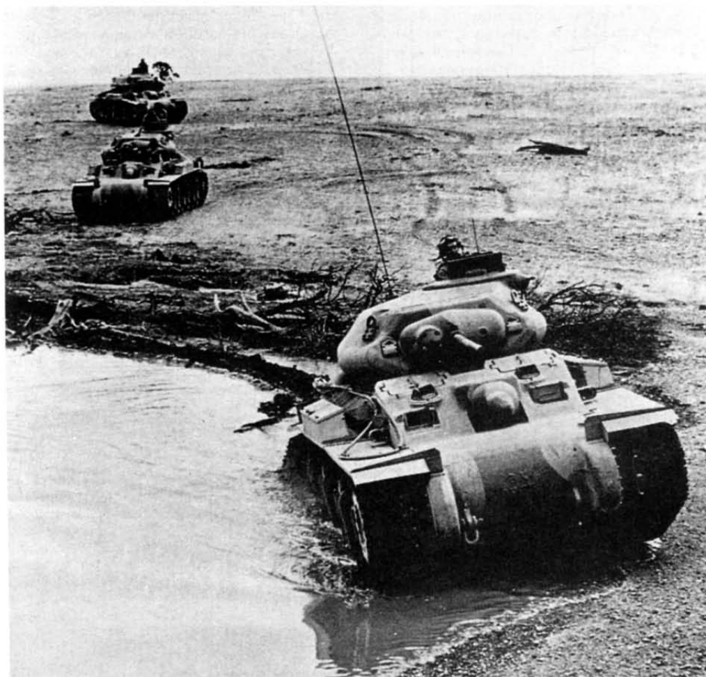
Подразделение танков Sentinel ACI на тактических занятиях. На головной машине хорошо видны литые броневые маски пушки и пулеметов
