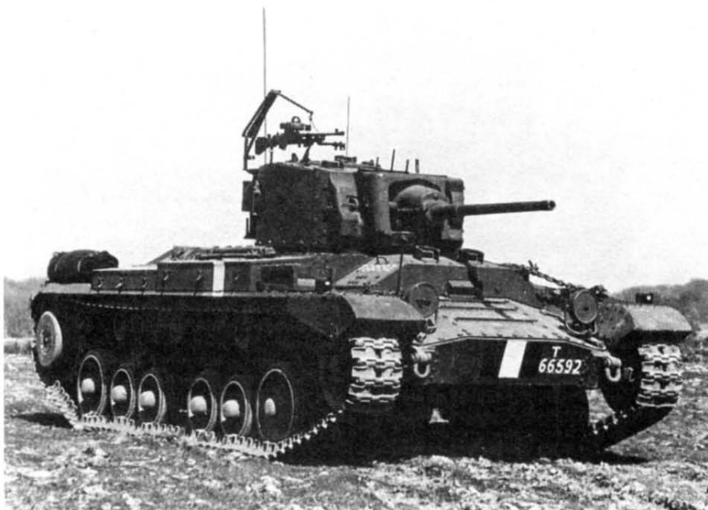
Пехотный танк Valentine III. На крыше башни смонтирована зенитная установка Lakeman для 7,7-мм пехотного пулемета Bren
