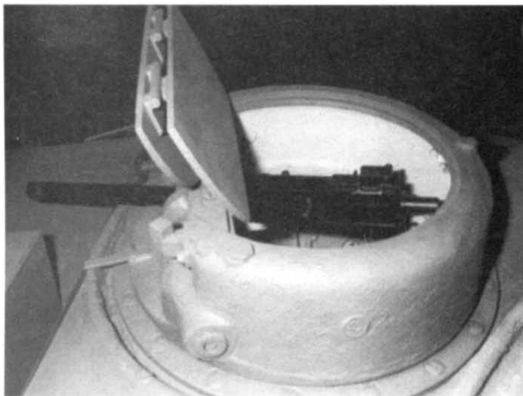
Пулеметная башенка с установленным в ней пулеметом Browning M1919A4
