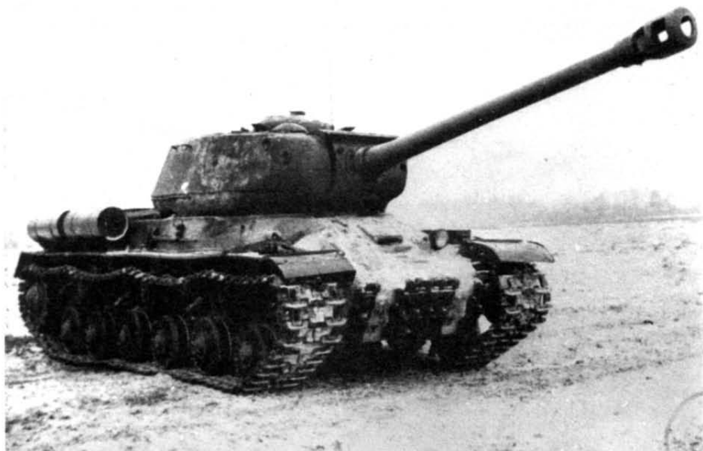
ИС-2 поздних выпусков 1944 г. с измененной носовой частью корпуса, расширенной амбразурой пушки и запасными траками на нижнем лобовом листе корпуса
