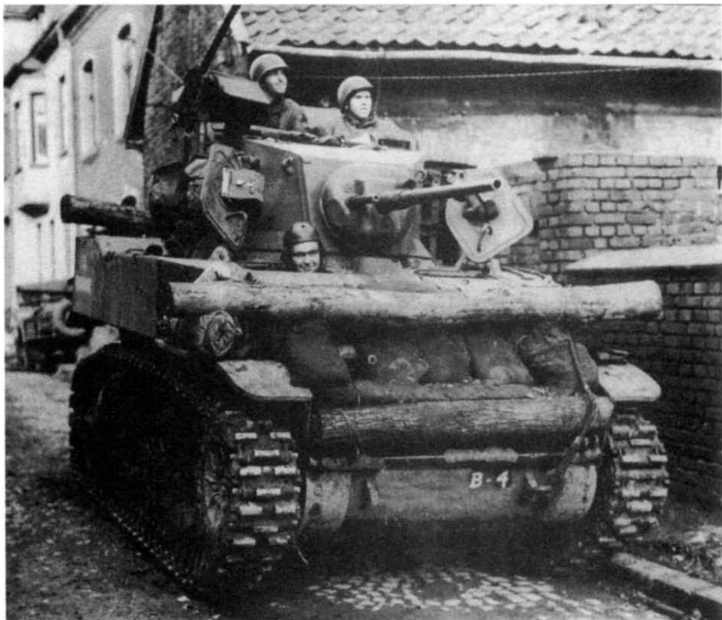
Легкий танк М5А1 из состава 67-го танкового полка 2-й танковой дивизии. Германия, ноябрь 1944 г. С помощью бревен и мешков с песком экипажи старались хоть как-то повысить защищенность своих машин
