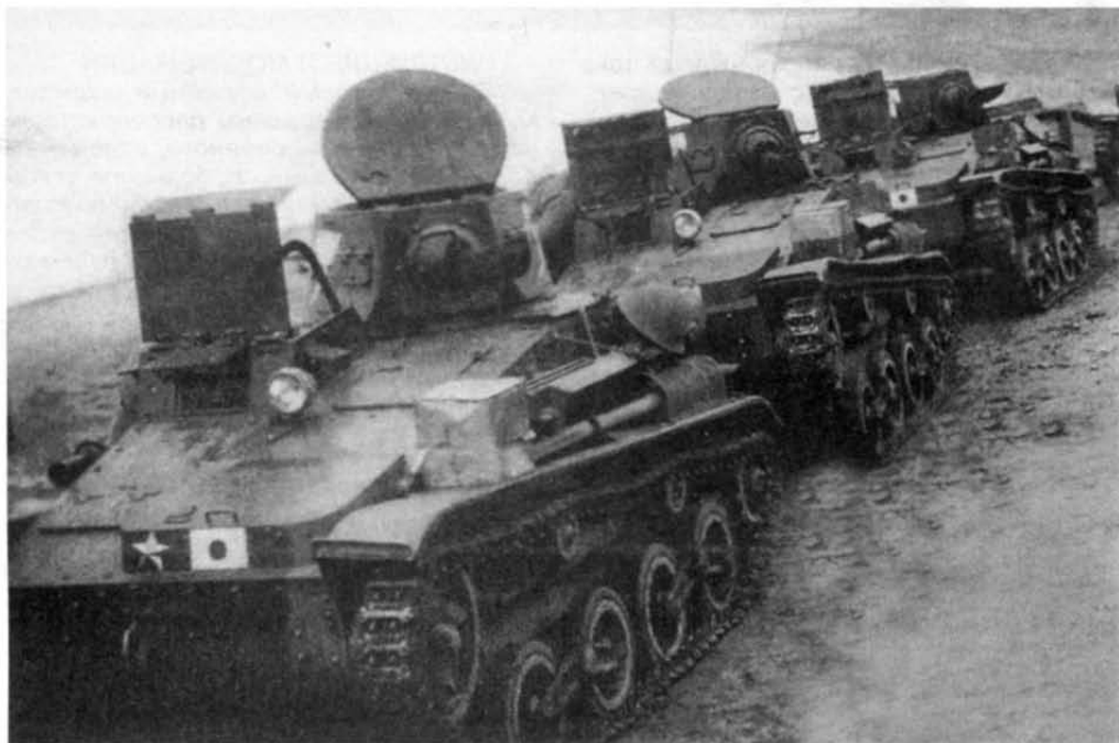
Колонна малых танков 2592 на привале во время боевых действий в Китае. Хорошо видна форма крышки посадочного люка механика-водителя
