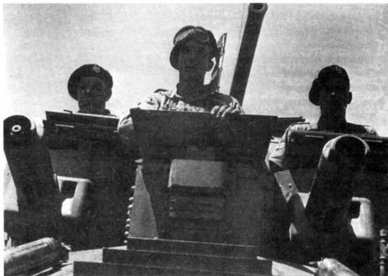
Механик-водитель (в центре) и оба пулеметчика на своих рабочих местах в танке Mk I. Обращают на себя внимание массивные броневые кожуха пулеметов Vickers
