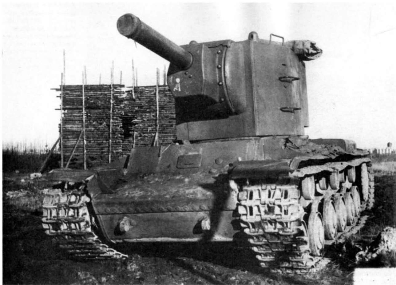
Тяжелый танк КВ-2 (предсерийный образец У-7 с первой башней МТ-2) перед испытаниями. Сентябрь 1940 г.
