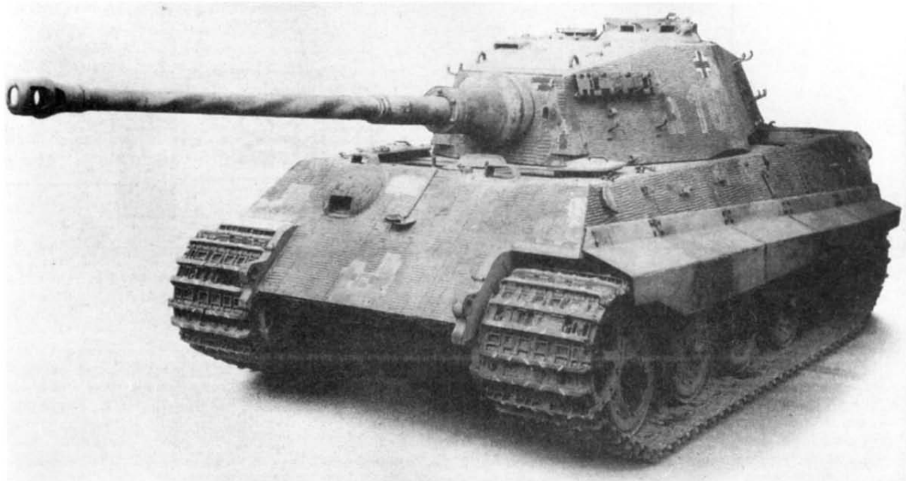
"Королевский тигр" выпуска 1945 года. Над амбразурой телескопического прицела установлен противодождовой козырек
