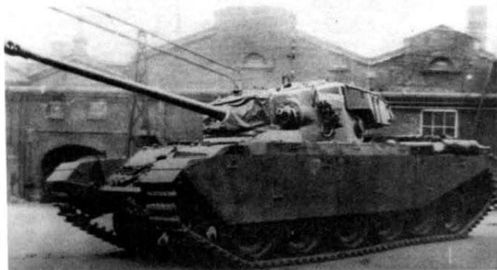
Серийный танк Centurion Mk 1. Шаровая установка пушки Polsten заменена на установку пулемета Besa, кроме того, на серийных машинах имелись ящики для снаряжения
