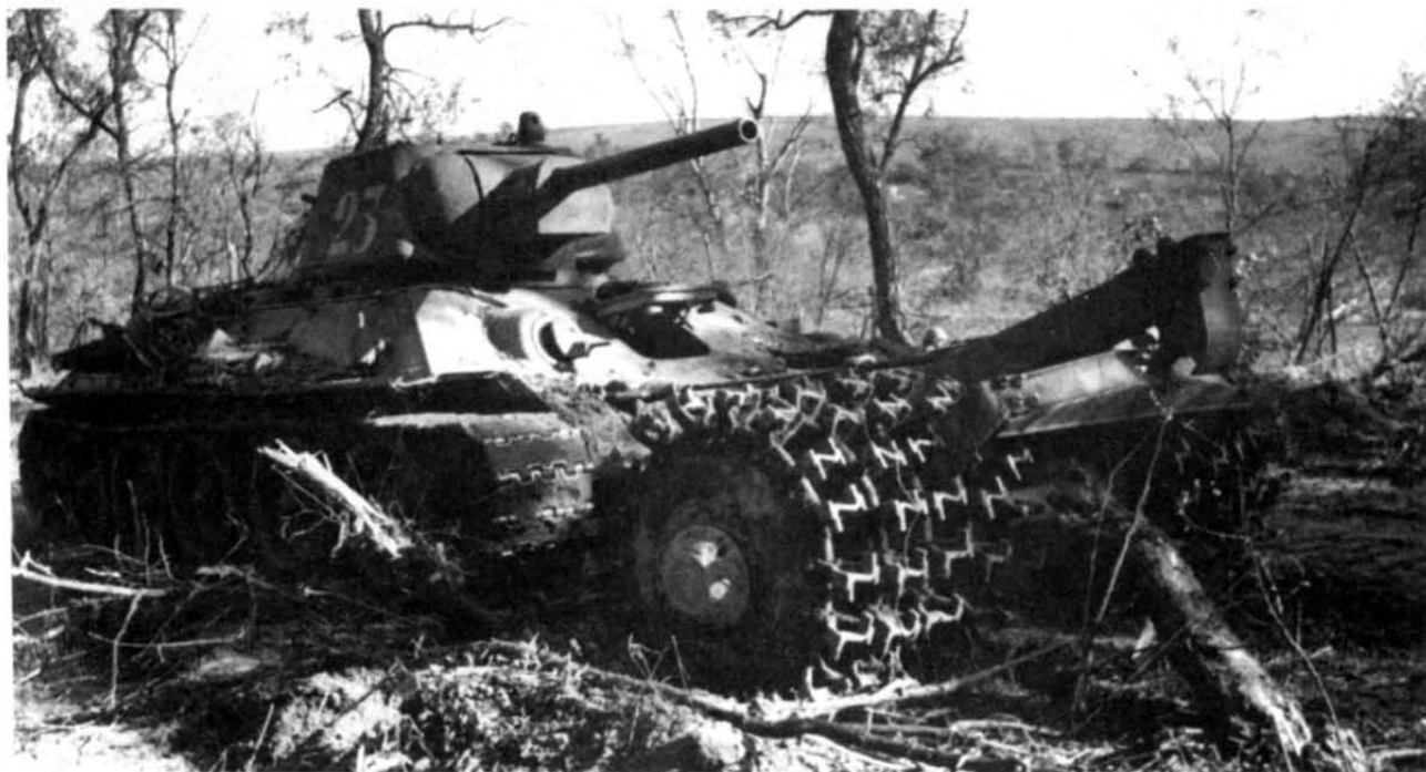
Танк Т-34, оборудованный колеиным катковым минным тралом ПТ-3. Курская дуга, лето 1943 г.
