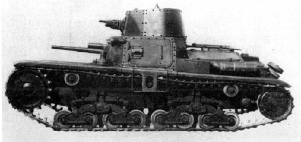
Серийный танк M11/39. Серийные машины отличались от прототипа отсутствием радиостанции и несколькими модифицированными крыльями
