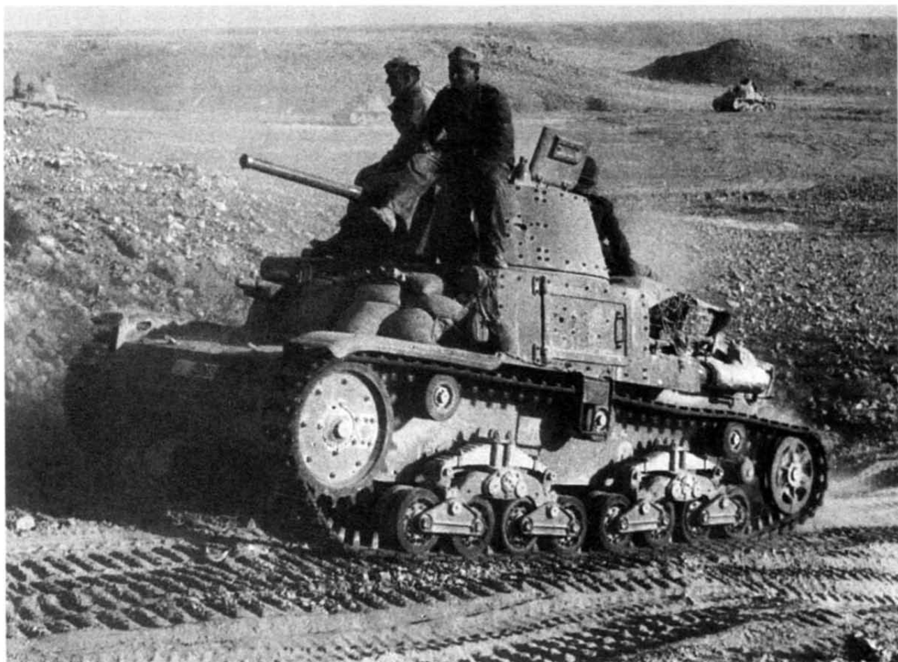
Стремясь хоть как-то усилить слабую бронезащиту своих машин, экипажи обкладывали танки М13/40 мешками с песком
