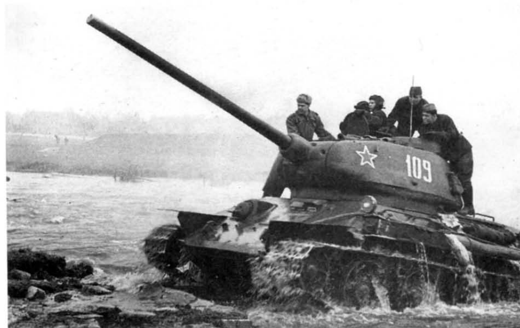
Т-34-85 позднего выпуска 1944 г. Нештатные грязевые щитки установлены, видимо, в ходе ремонта. Довольно редкий снимок, на котором хорошо видны полностью открытые "ресницы" — броневые крышки призм приборов наблюдения механика-водителя
