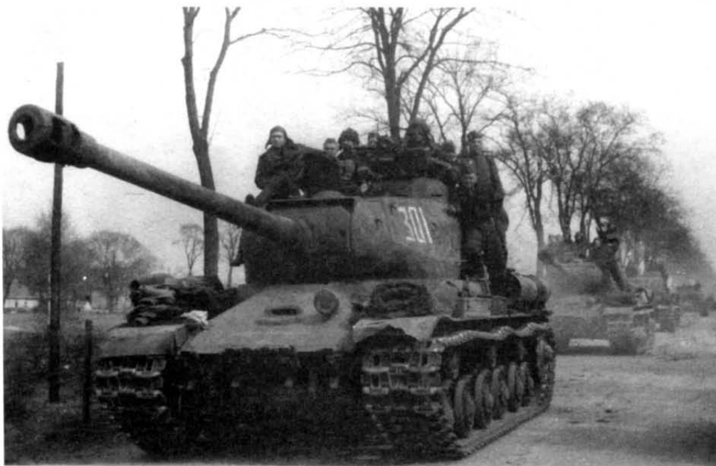
На улице г. Штарград, Восточная Пруссия, 2-й Белорусский фронт, 19 марта 1945 г. У этого ИС-2 отсутствовала зенитно-пулеметная установка и для борьбы с "фаустниками" использовался пулемет ДТ с пехотными сошками
