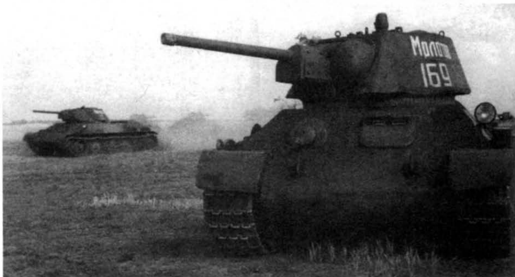
Литая "улучшенная" башня производства Уралмашзавода. 1942 г.
