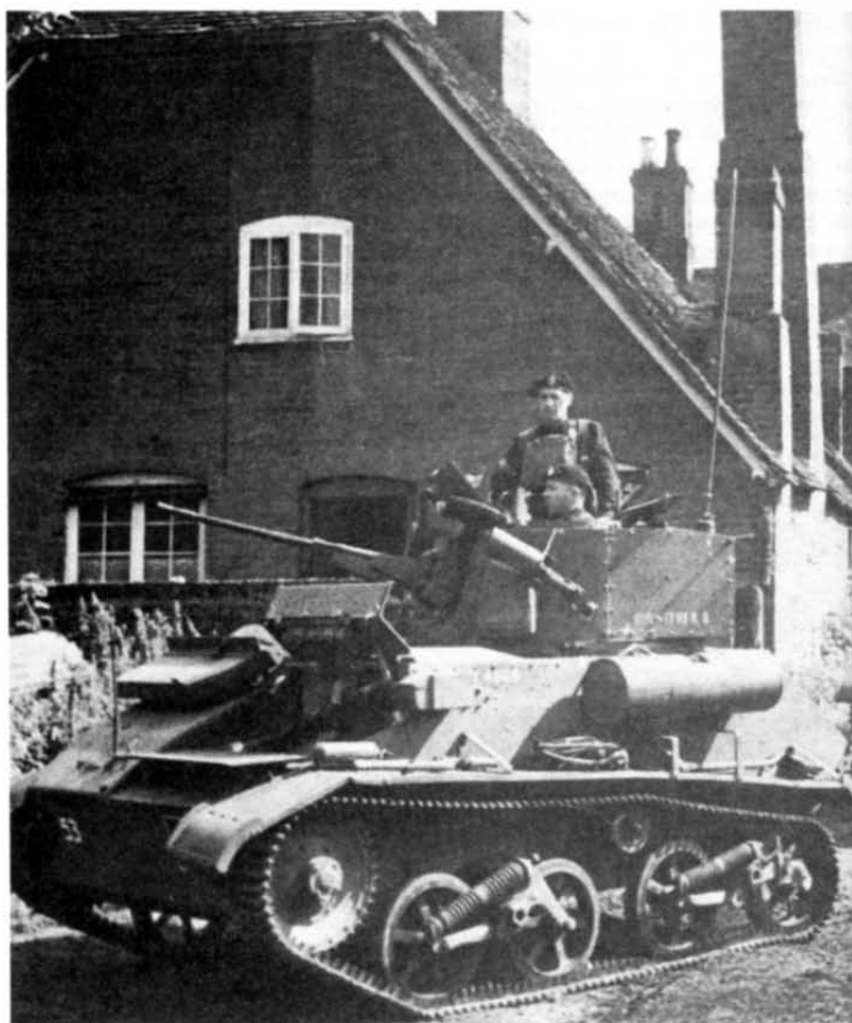
Легкий танк Vickers Mk VIC. Эта машина привлекалась к охране одного из аэродромов в Англии. 1941 г.
